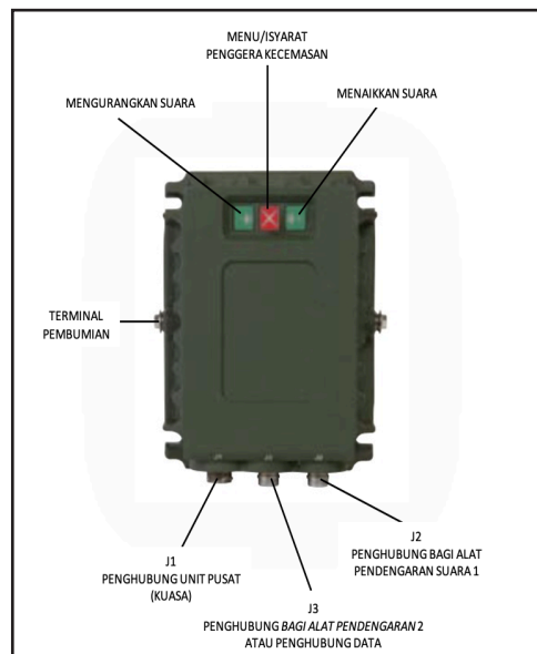
Rajah 5: RF-7800I-BU Unit Asas dari permukaan hadapan.
