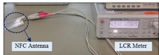
Rajah 5: Pengukuran kearuhan dan rintangan antena menggunakan Jambatan LCR HM8118.
